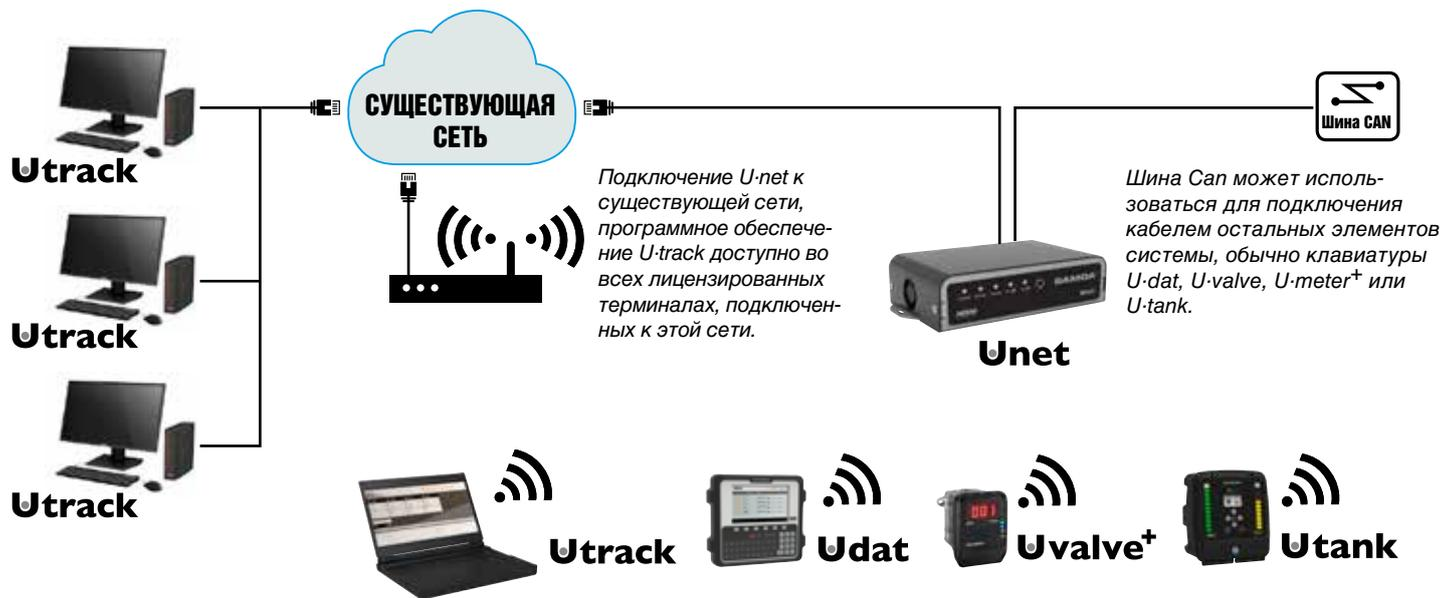
Если сеть использует Wi-Fi®, компоненты NEX-U.® с Wi-Fi® могут подключаться к сети через Wi-Fi®. Дополнительно доступ к U-track могут иметь прочие лицензированные терминалы (ноутбуки, планшеты, смартфоны).
