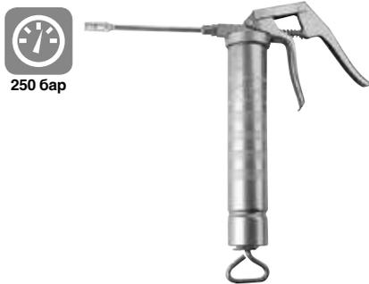
Насос для консистентной смазки с пистолетной ручкой для смазки в труднодоступных точках. Три способа заправки: смазочные патроны 400 г (14 унций), всасывание из емкостей, заливочный насос. Сверхпрочная чугунная крышка с поршнем с точной посадкой. Максимальное рабочее давление: выше 250 бар (3650 фунт/кв. дюйм).
