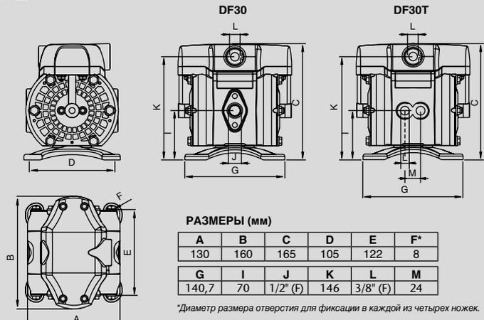
\*Диаметр размера отверстия для фиксации в каждой из четырех ножек.
