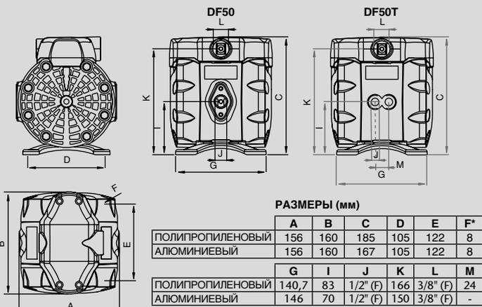
\*Диаметр размера отверстия для фиксации в каждой из четырех ножек.
