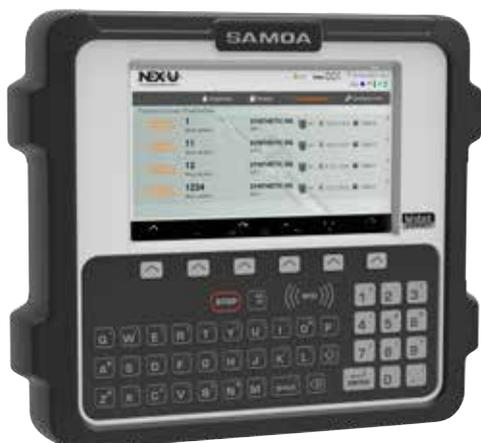
Клавиатура доступа в систему включает 7" полноцветный графический дисплей и полную клавиатуру QWERTY. U-dat открывает доступ в систему операторам через PIN код или RFID карту.
