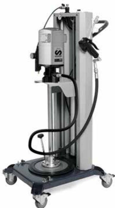
Мобильная установка специально спроектирована для использования с липкими и высоковязкими консистентными смазками, которые трудно перекачивать (до NLGI-3). К нижнему концу насоса прикреплена экструзионная пластина. Насос установлен на пневмоцилиндр, который поднимает насос, чтобы заменить пустое ведро. Пневмоцилиндр оказывает давление вниз, вдавливая насос и следящую пластину в смазку, и таким образом способствуя работе насоса, позволяя качать очень вязкую консистентную смазку.
