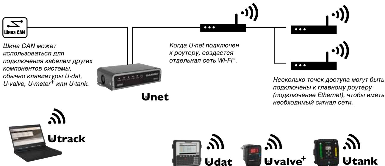
Лицензированные терминалы (ПК, планшеты, смартфоны) могут быть подключены к сети NEX-U.® и иметь доступ к компонентам системы NEX-U.® через U-track.
