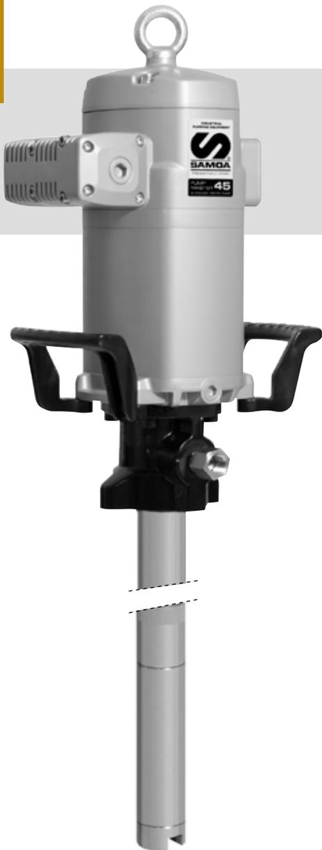
Высокопроизводительный насос умеренного давления двойного действия для перекачки консистентной смазки до NLGI-2. Также рекомендован для использования со смазками низкой вязкости в централизованных системах раздачи смазки, которые не требуют очень высокого выпускного давления, и в больших системах раздачи масел высокой вязкости.
