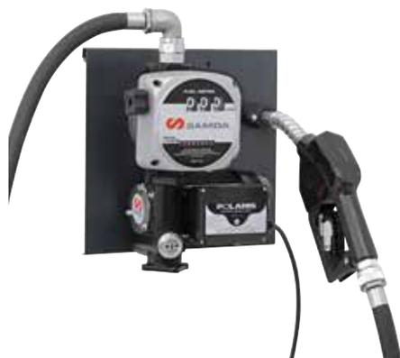
Насос с производительностью 50 или 70 л/мин серии POLARIS с крепежной пластиной для монтажа на стену или бак. Комплект включает насос для перекачки дизельного топлива 230 В, 50 Гц с переключателем ВКЛ/ВЫКЛ, кабель 1,8 м с вилкой, крепежную пластину, подающий шланг 4 м, пистолет и трехразрядный счетчик (№ 680 300) с шарнирным угловым патрубком 90°, который прифланцовывается к насосу. Соединение на впуске жидкости 1" BSP (F).
