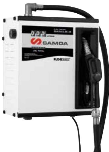
Насос с производительностью 50 или 70 л/мин серии POLARIS в шкафу для монтажа на стену или бак. Комплект включает насос для перекачки дизельного топлива 230 В, 50 Гц, кабель 1,8 м с вилкой, шкаф с держателем пистолета с автоматическим переключателем вкл/выкл, подающий шланг 4 м, автоматический пистолет и трехразрядный счетчик с шарнирным угловым патрубком 90°, который прифланцовывается к насосу. Соединение на впуске жидкости 1" BSP (F).
