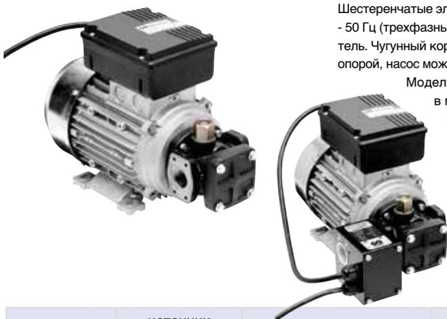
Шестеренчатые электрические насосы для смазочных материалов. 230 В - 50 Гц (однофазный) или 380 В - 50 Гц (трехфазный) мотор, в зависимости от модели, класс защиты IP55 и двухпозиционный переключатель. Чугунный корпус мотора, шестерни из спеченной стали и байпасный клапан. Двигатель с монтажной опорой, насос может монтироваться горизонтально на плоскую поверхность или вертикальную стену.
