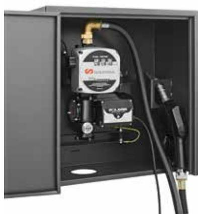
Насос с производительностью 50 или 70 л/мин серии POLARIS в шкафу с замком для монтажа на стену или бак. Комплект включает насос для перекачки дизельного топлива 230 В, 50 Гц, кабель 1,8 м с вилкой, шкаф с держателем пистолета с автоматическим переключателем вкл/выкл, подающий шланг 4 м, автоматический пистолет и трехразрядный счетчик с шарнирным угловым патрубком 90°, который прифланцовывается к насосу.
