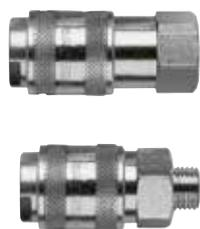
Латунные, с никелированным корпусом, изнашиваемые части из нержавеющей стали для большего срока службы. Совместимость: US MIL C4109 - ISO 6150 B12. Пропускная способность: 1000 л/мин.
