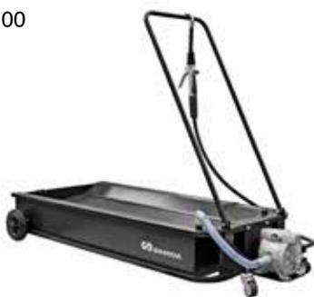
Низкопрофильные подкатные ванны для сбора отработанного масла и автомобильных жидкостей, таких как растворы антифриза. Рекомендовано для использования при отсутствии подъемника и смотровой ямы. Опорожнение самотеком через спускной кран или с помощью комплекта с насосом для откачки (№ 559 100) через гидравлический соединитель (№ 950 352) (не входит в комплект поставки).
