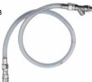
**367 022** Комплект откачки для насосов DF50. Включает гидравлический соединитель 3/4", всасывающий шланг 1,5 x 3/4", Y-фильтр и переходники для установки комплекта на алюминиевый насос DF50.
