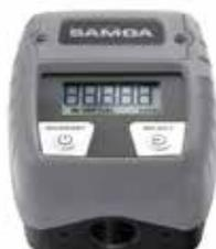
**366 010** Счетчик с овальными шестернями для AdBlue®/DEF, 1/2" BSP (F) Счетчик с овальными шестернями, сделанный из ХПВХ, нержавеющей стали и LCP (полимер) для AdBlue®/DEF. Цифровой дисплей работает от двух щелочных батареек AAA. Впускная/выпускная резьбы 1/2" BSP (F). Производительность: 1-50 л/мин.
