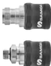
Быстросъемные муфты безопасности для сжатого воздуха. Одношаговое разъединение и выхлоп воздуха быстро понижает давление в системе, обеспечивая безопасное разъединение. Изготавливаются из нержавеющей стали, никелированной латуни, нитрильного каучука и технополимера. Муфты соответствуют стандарту ISO 6150 B12. Пропускная способность: 1200 л/мин. Давление: от 1 до 15 бар.
