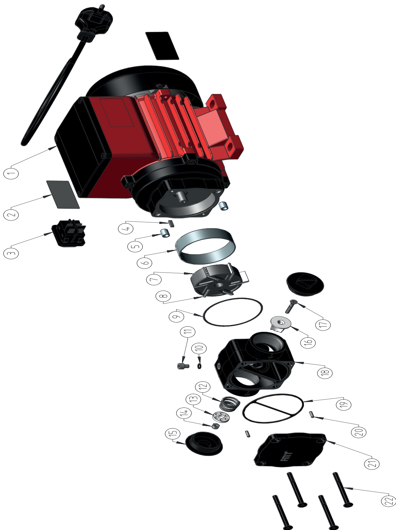
Рис. 15.-1: Покомпонентный вид дизельного насоса 60 л / мин
