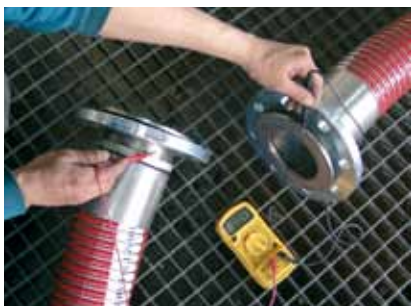
Conductividad eléctrica. Electrical continuity.
